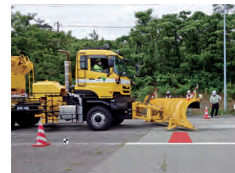
除雪ブラウの自動制御(上げ下げ)試験の様子。テストフィールドに仮想の橋りょうジョイント(図中赤枠部)を設定し、除雪トラックを通常の作業速度で走行させ、仮想の橋りょうジョイント部で除雪ブラウを自動で上下させる試験
