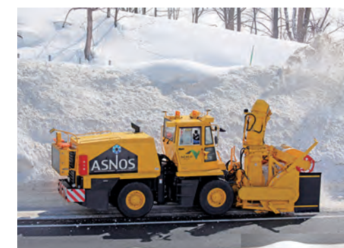
自立走行機能付きロータリ車の試験走行
