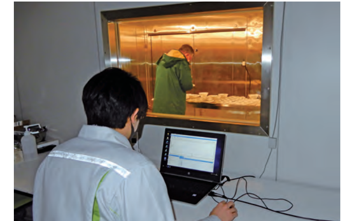
低温恒湿試験機による凍結防止剤の固結試験
